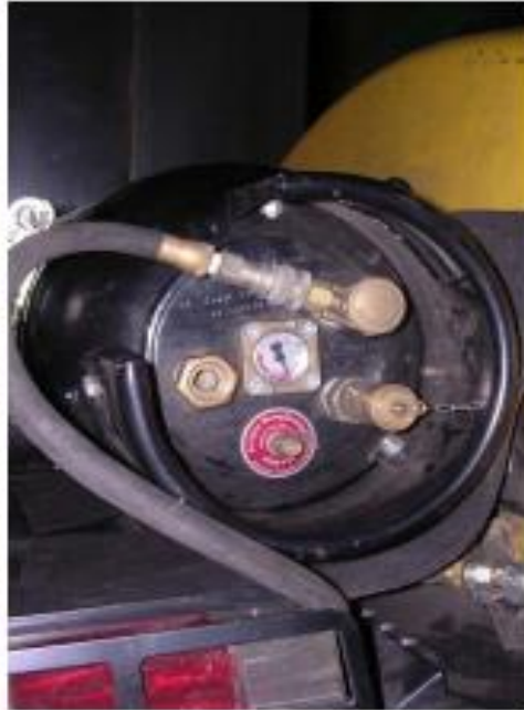
Foto 2: LPG-wisselreservoir - er zijn meerdere (minimaal twee) aansluitingen
