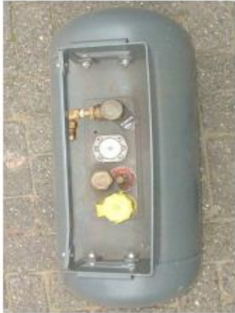
Foto 1: LPG-wisselreservoir - er zijn meerdere (minimaal twee) aansluitingen
